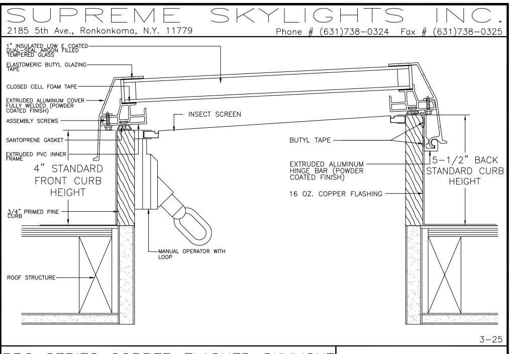
PRO SERIES COPPER FLASHED SKYLIGHT FLAT ROOF VENTED CUT FLUSH
