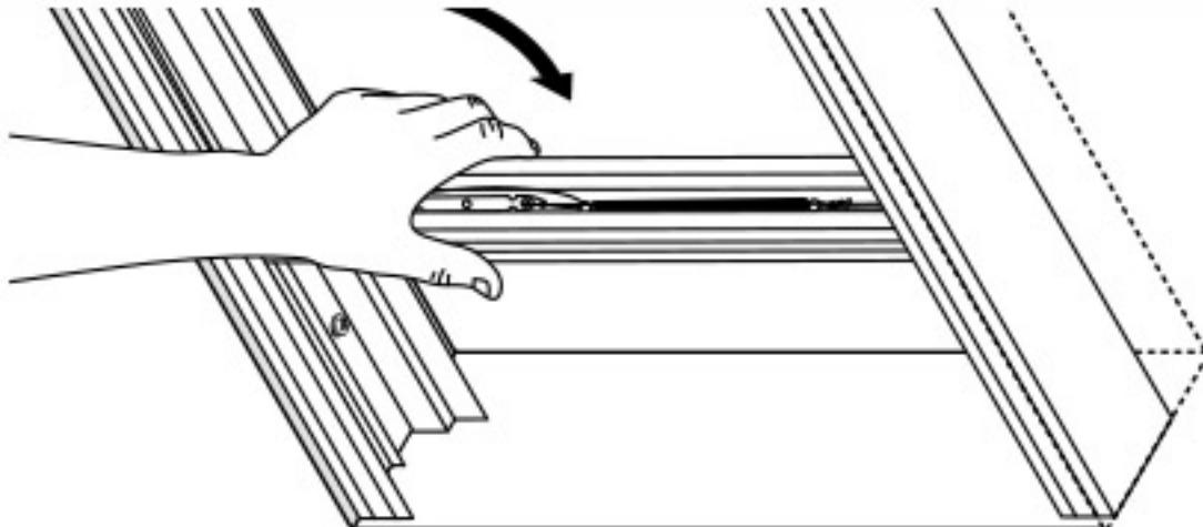
**10****Lower bottomrail and mark screw locations****Baje el riel inferior y marque las ubicaciones de los tornillos****Abaïsser la barre inférieure et marquer l'emplacement des vis**
